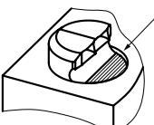
Los insertos gripp y los insertos de sujeción con recubrimiento de metal duro deben estar empotados.
