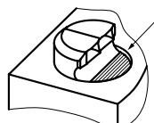
Зажимные вставки и вставки с твердосплавным покрытием должны быть утоплены.
